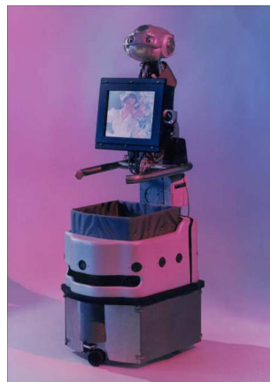
Abbildung 3 — Pearl, eine mobile Roboter Plattform für Autominder (Quelle: [Pol05])
